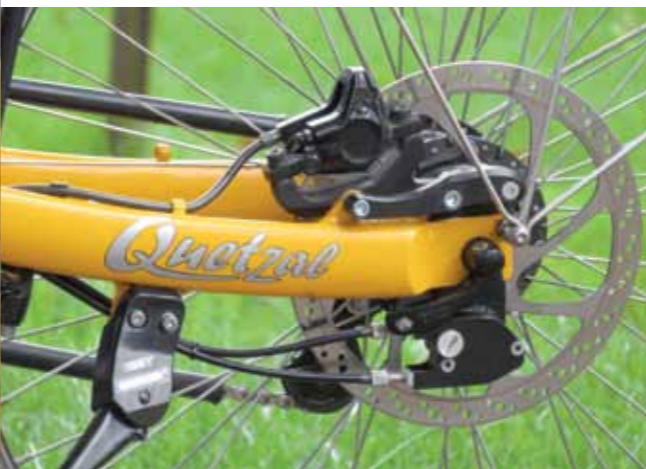
Tevens een dikke schijf aan de achtersvork. Externe schakelbox voor Rohloff; nette montageplaat voor een standaard.
