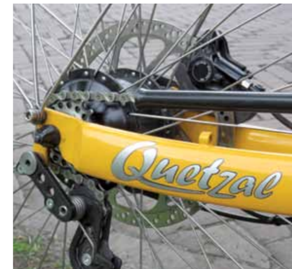
Rohloff-naaf met kettingspanner.
